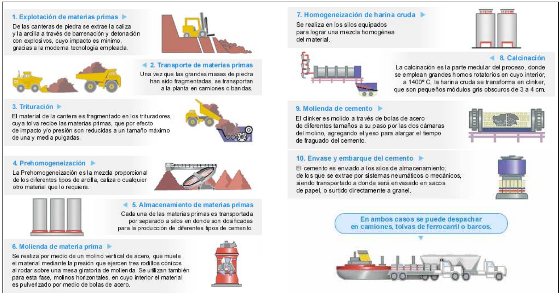
Gráfico 16. Proceso de fabricación de cemento
